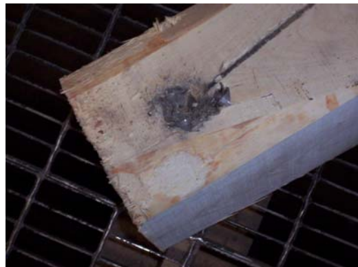
f. Présence de corps étrangers Non acceptable
